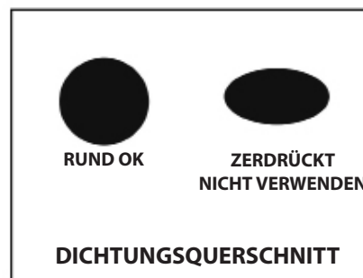
Abb. E – Deckeldichtung
