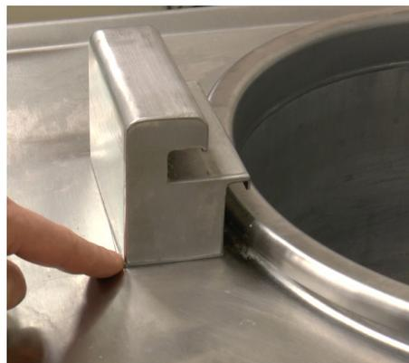
Рис. 7. Уплотнитель защелки крышки
