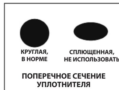
Рис. 5. Уплотнитель крышки
